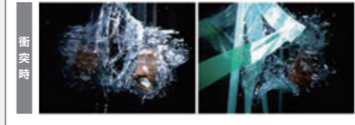
植木鉢のような飛来物でもガラスが割れ、室内に飛び散ってしまいます。
